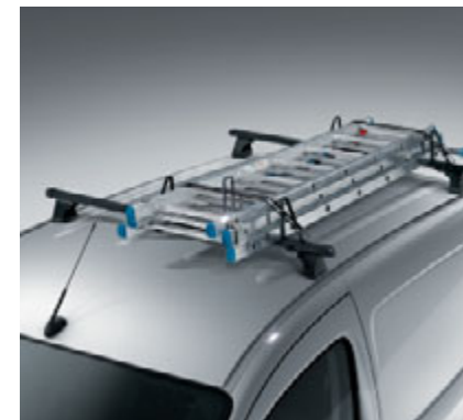
Držák žebříků. Pro bezpečnou přepravu různých žebříků na střeše vozidla. Pouze v kombinaci s nosičem nákladu.
