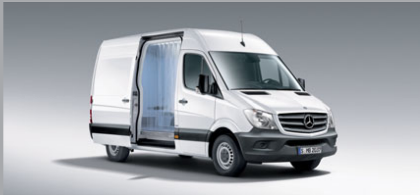
Sprinter s chladiřenskou nástavbou 1 a závěsem pro udržení chladu.
