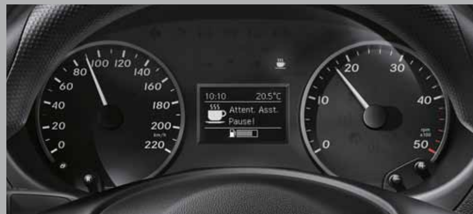
Standardně dodávaný asistent sledování bdělosti ATTENTION ASSIST dokáže pomocí četných parametrů rozpoznat typické známky únavy a varovat řidiče.
