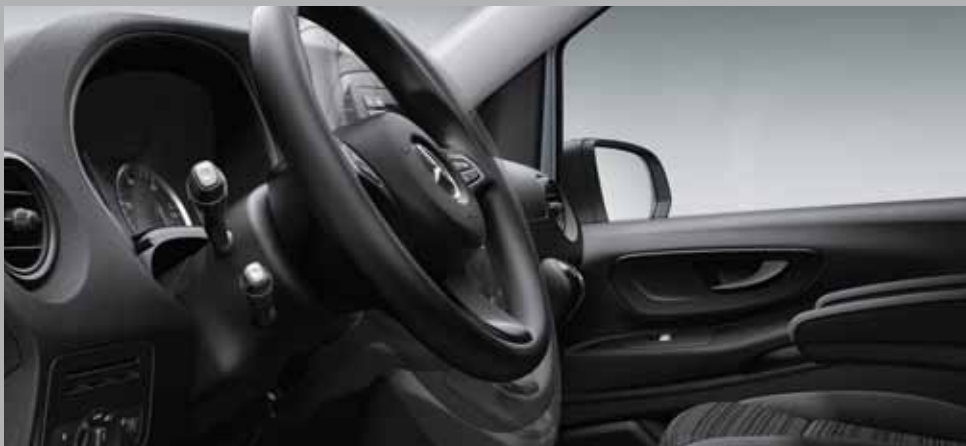
Volant s možností nastavení sklonu a výšky umožňuje individuální, ergonomické držení těla pro řidiče s různou tělesnou výškou.
