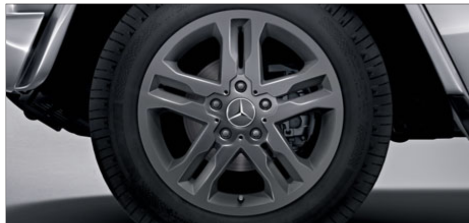
5dvouloukoťová kola z lehkých slitin s pneumatikami 265/60 R 18, v barvě titanium šedá (dostupné pouze v kombinaci se sadou Sport, kód RM9).
