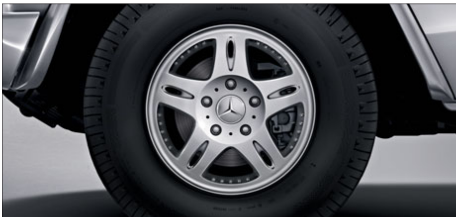
5loukoťová kola z lehkých slitin s pneumatikami 265/70 R 16 (stand. výbava pouze u G 350 BlueTEC, kód RL3).
